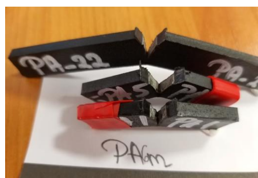
a) Câteva eșantioane, după testarea la impact cu 1 m/s, cele tăiate sunt pregătite pentru investigație SEM
