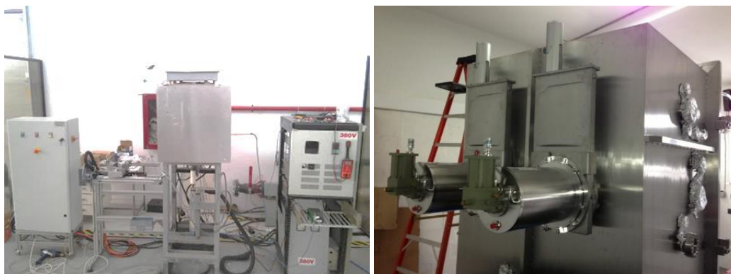
Instalația de depunere EB-PVD (IMNR) și de testare soc termic (INCAS)
